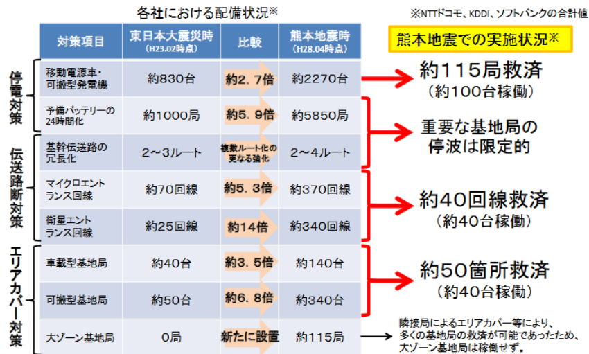
図 2.6-2 熊本地震の応急対策
